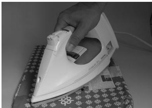
รูปที่ 18.6 การรีดลายวงจรลงบนแผ่นทองแดง
