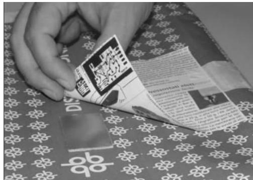
รูปที่ 18.5 การนำลายวงจรวางทาบบนแผ่นทองแดง
