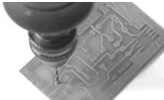
รูปที่ 18.13 การเจาะรูแผ่นปริ๊นท์ด้วยสว่าน
