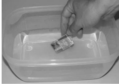
รูปที่ 18.7 ลายวงจรบนแผ่นทองแดงหลังการรีด
