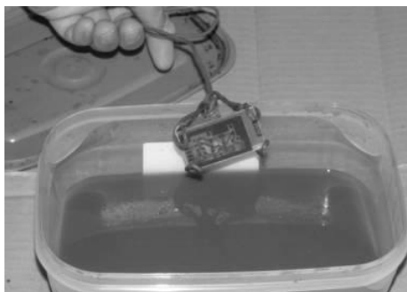
รูปที่ 18.9 นำแผ่นทองแดงไปกัดด้วยกรดกัดปริ้นท์
