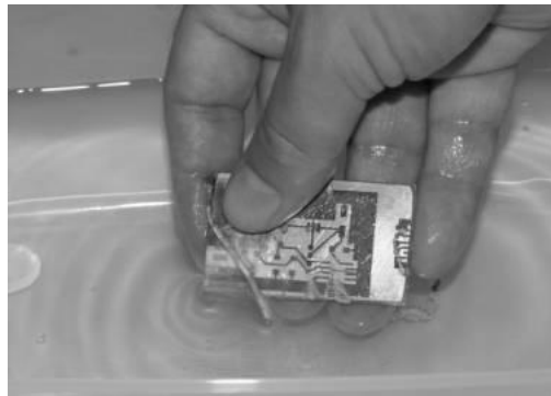
รูปที่ 18.8 การล้างกระดาษลายวงจรออกจากแผ่นทองแดง
