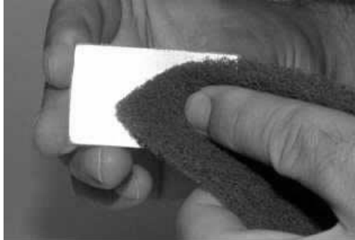
รูปที่ 18.4 การทำความสะอาดแผ่นทองแดง
