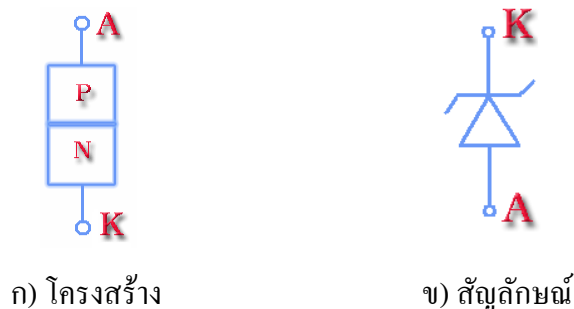
รูปที่ 5.1 โครงสร้างและสัญลักษณ์ของซีเนอร์ไดโอด
