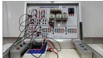
ภาพที่ 4 ทดสอบวงจรควบคุมการสตาร์ทมอเตอร์โดยตรง
